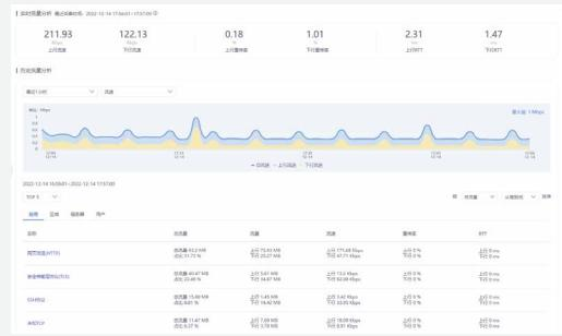
通过流量排行识别到异常对象后，支持对每个对象进行下钻分析，查看单个对象的指标变化趋势和流量构成，最终定位到可能存在异常的访问IP。
