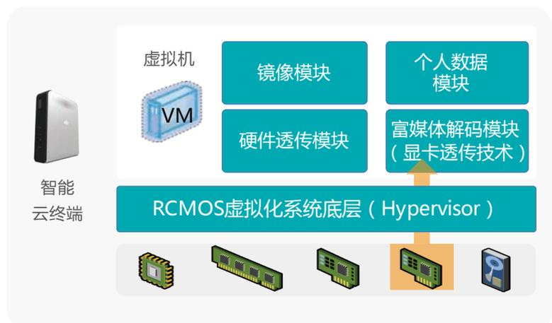
显卡透传技术使终端可提供最佳的富媒体体验，完美支持3D图形。
